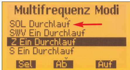
Bild 11a: SOL-Kompensation für die aktuellen Frequenzen einer Mehrfrequenzmessung
