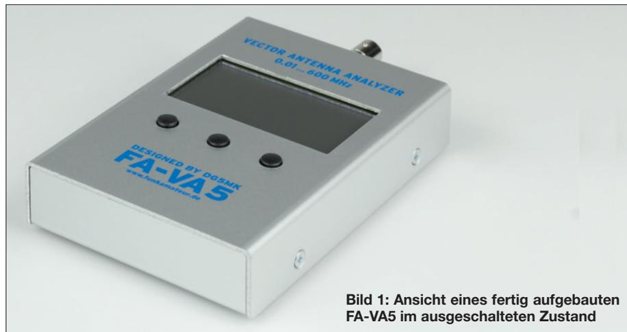
**Bild 1: Ansicht eines fertig aufgebauten FA-VA5 im ausgeschalteten Zustand**
