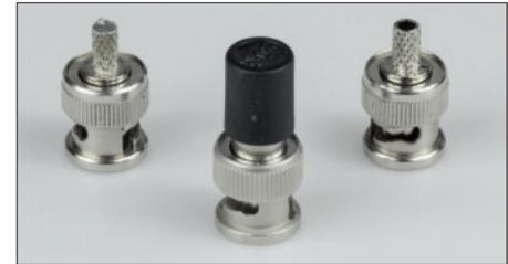
**Bild 10:** Der Bausatz enthält einen Satz Referenzelemente für den Frequenzbereich bis etwa 100 MHz: einen 50- $\Omega$ -Abschlusswiderstand von *Telegärtner* (Mitte) sowie zwei BNC-Koaxialkabelstecker zur Anfertigung der *Short*- und *Open*-Referenzelemente (s. Text).
