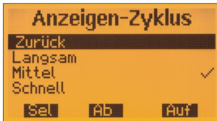
Bild 28: Der Anzeigenzyklus kann *langsam*, *mittel* oder *schnell* gewählt werden.
