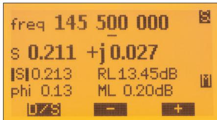
Bild 17: Einzelfrequenz-Messung des Reflexionskoeffizienten
