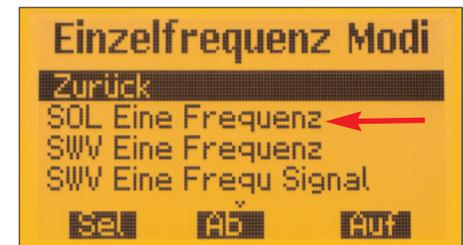
**Bild 11:** Menüpunkt zur SOL-Kompensation für eine aktuelle Frequenz
