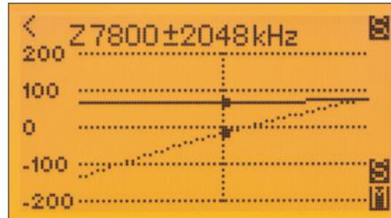
**Bild 20b:** Beispiel für die Mehrfrequenzmessung der Impedanz; bei Plus-/Minus-Tastendruck ändert sich jetzt die Mittenfrequenz des Wobbelbereichs, da der Pfeil links oben nach links zeigt.
