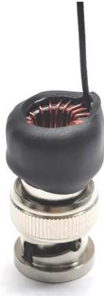
Die EFHW ist eine Resonanzantenne, die ohne Tuner verwendet werden kann. Diese Antennen sind auch auf jedem Halbwellenmultiplikator resonant, so dass eine 40-m-EFHW auch auf 20, 15 und 10 m resonant (oder nahezu resonant) ist. In der Praxis sind in der Regel einige Antennentricks erforderlich, um die Abstimmung auf diesen zusätzlichen Bändern zu optimieren. Wir werden die Optionen später behandeln.
