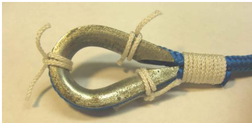
Bild 16: Kausche mit Hilfsseilen fixiert
